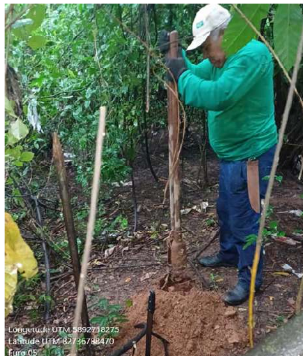
FURO 04 E 05 - ESTACA 20 E 21 SOLO INSERVÍVEL
